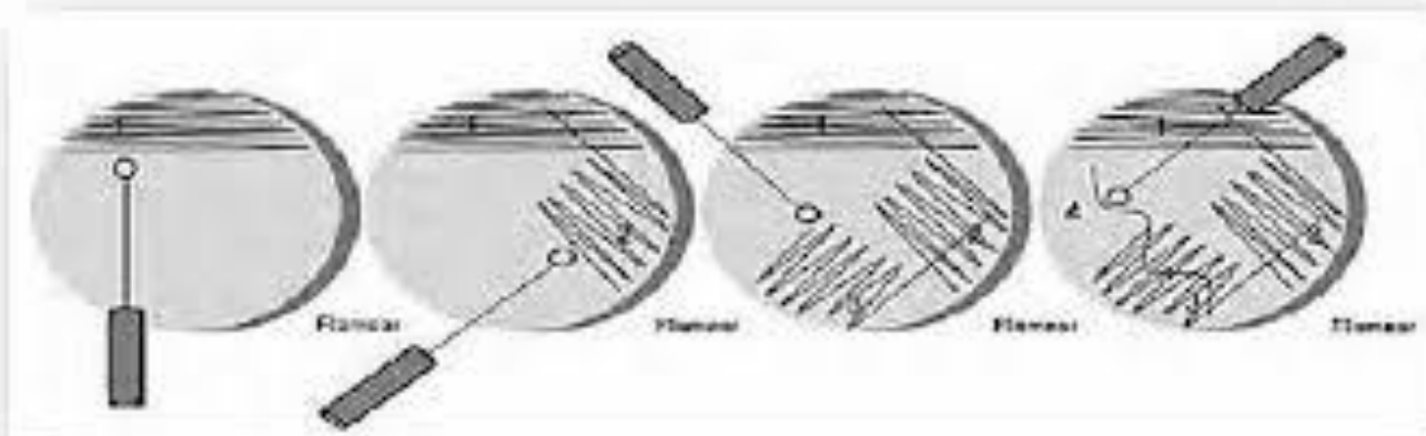
Fig 2. Técnica de agotamiento por estría en placas de Petri con medio sólido
