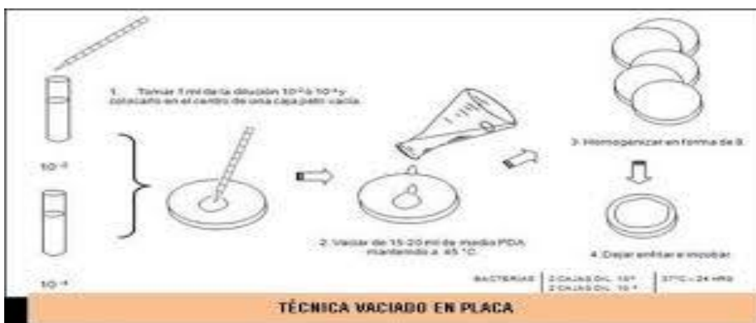
Figura 4. Técnica de vaciado en placa
